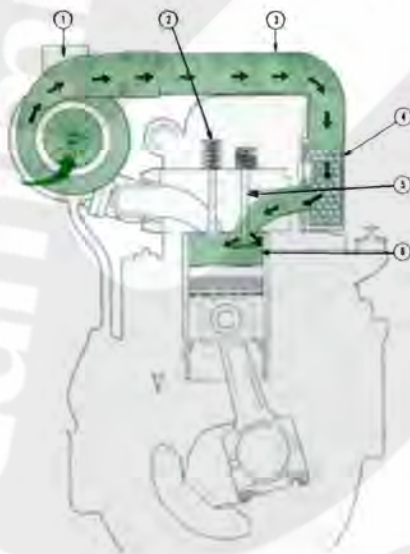
图 5-16 KTA19 型发动机进气流向图
